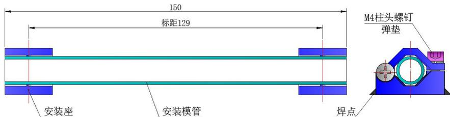
待安装座冷却后取下安装模管将应变计装入安装座内，应变计应处于两安装座正中间，且出线盒朝上。
