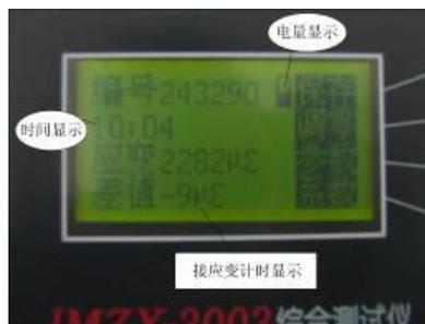
● 其中“电子编号”功能，能防止因传感器导线被剪或导线编号丢失后，致使无法使用的现象。
